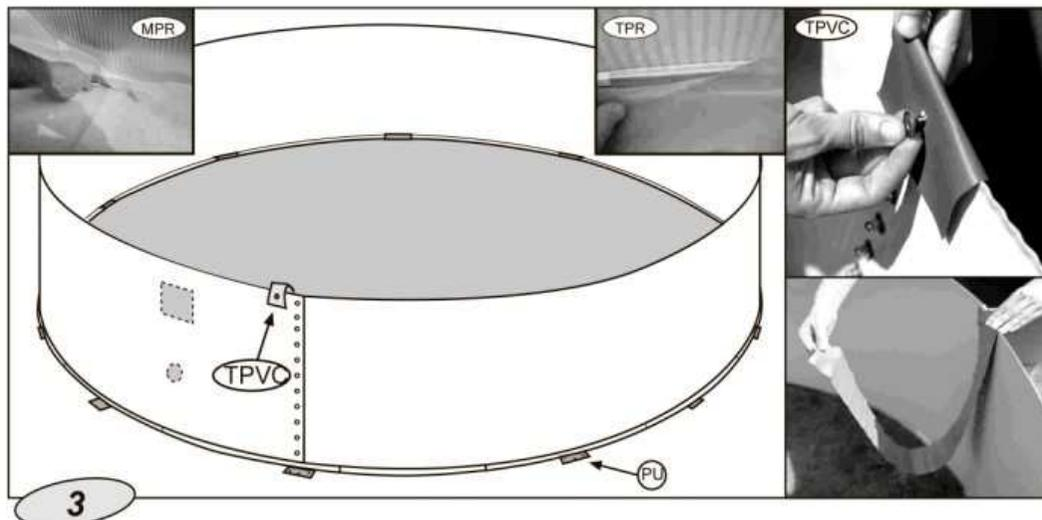
**ЗАЩИТНАЯ ПОЛОСА ПВХ (ВНУТРИ БАСЕЙНА):** закрепите полосу к верхнему борту за болт и растяните по внутренней части бассейна, чтобы закрыть шов.
