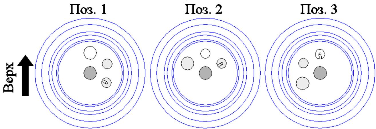
Включение и выключение противотока (универсал.) (54 м<sup>3</sup>/ч 380В 2.2 кВт) JET-SWIM 1200 Pahlen производится путем нажатия пневмокнопки (см. рис. 6 поз. 3), расположенной в середине лицевой панели закладного узла.
