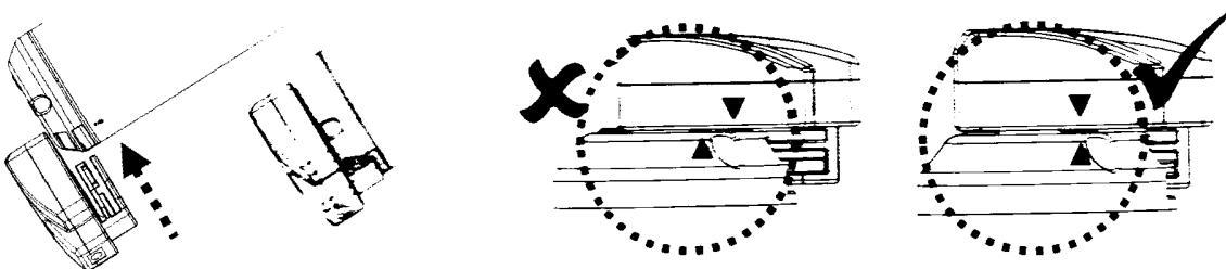
2. Подключите гнездо наружного переходника к зарядному устройству на торце зарядного устройства.
