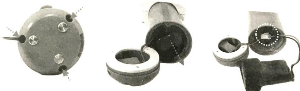
2. Чтобы отсоединить провод батареи, нажмите на зажим на соединителе и вытащите его. ПРИМЕЧАНИЕ: немедленно обмотайте соединитель изоляционной лентой, чтобы избежать короткого замыкания, вызванного касанием обоих клемм.
