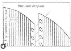
О. Чтобы точно совместить отверстия, необходимо отрегулировать диаметр бассейна. Это можно сделать при помощи легких ударов по кронштейнам основания каркаса с внешней или внутренней стороны.
