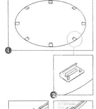
5 Вставьте загнутые рейки нижних направляющих в кронштейны основания каркаса и сдвиньте. Между концами соседних реек необходимо оставить зазор шириной ½" (13 мм).
