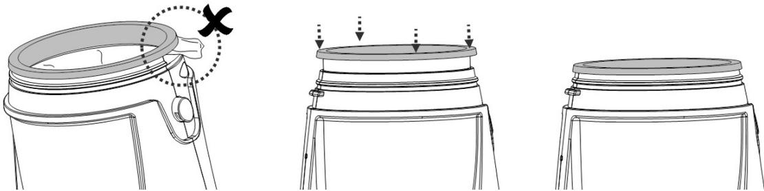
Para re-instalar el contenedor transparente al cuerpo principal, alinee el orificio del lado trasero con el gancho del cuerpo principal y apreté el contenedor transparente en el cuerpo principal. Asegúrese que el orificio de bloqueo del contenedor transparente quede fijado con el botón de bloqueo.
