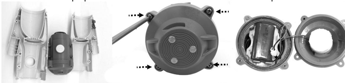
4. Retirer le pack de batterie du compartiment principal. Pour détacher le pack de batterie, appuyer sur le clip du connecteur et tirer le fil. NOTICE: Emballer immédiatement le connecteur avec de l'isolant afin d'éviter un court circuit si les deux bouts de fils se touchent.
