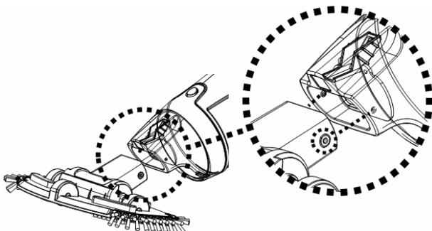
**ПРИМЕЧАНИЕ.** Чтобы заменить щетки на всасывающей головке, поднимите один конец и вытащите щетку, чтобы освободить место для новой.
