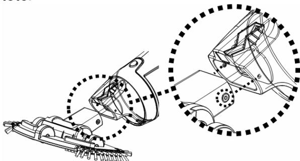
NOTE : Pour remplacer les brosses sur la tête d'aspiration, soulever l'extrémité et la pousser dehors pour laisser un espace pour une nouvelle.
