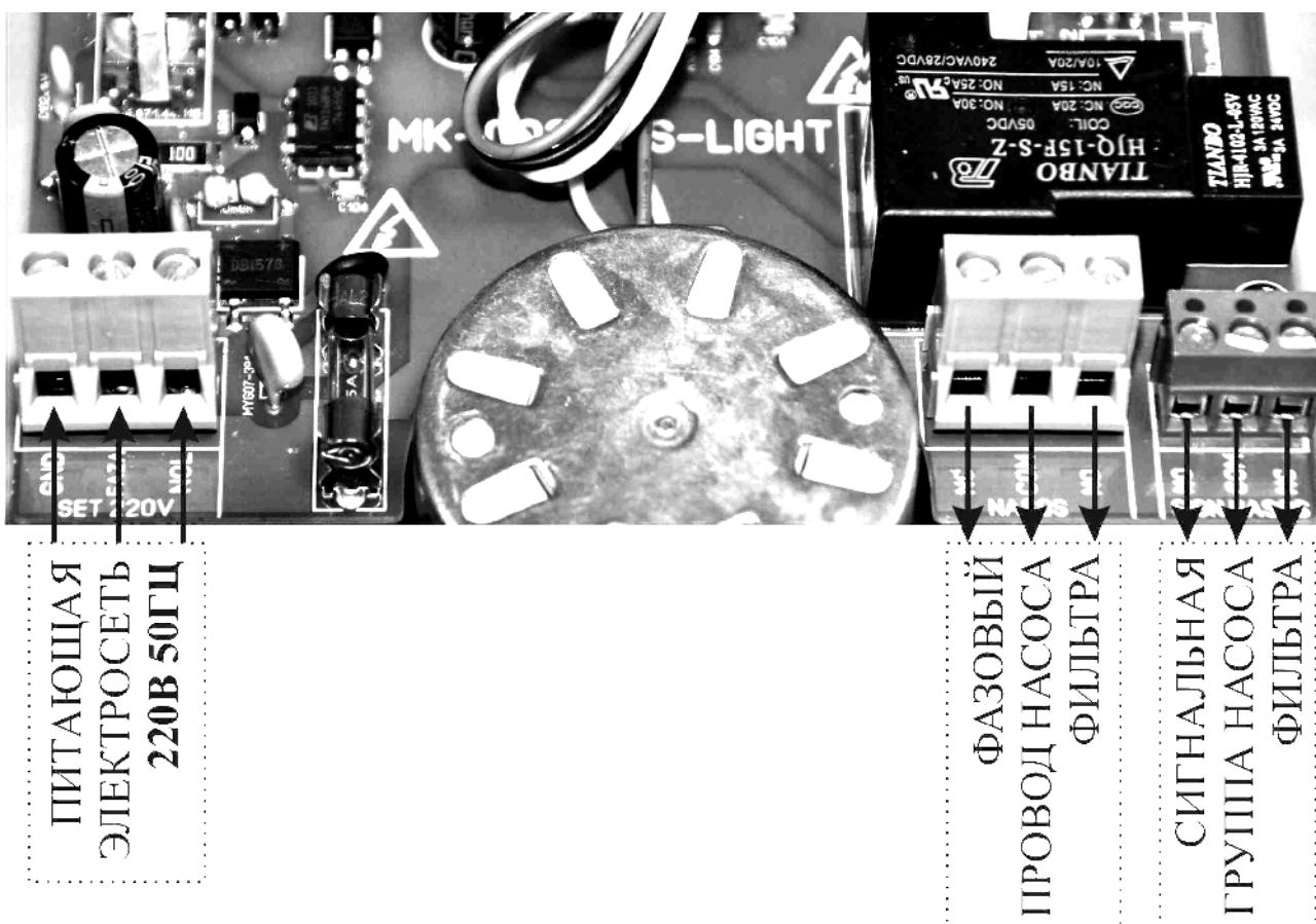
**«SET 220V» - ПИТАЮЩАЯ ЭЛЕКТРОСЕТЬ 220В 50ГЦ** – Электросеть 220В 50Гц с нулевым и заземляющим проводником, подключать строго в соответствии с указанными на плате надписями.
