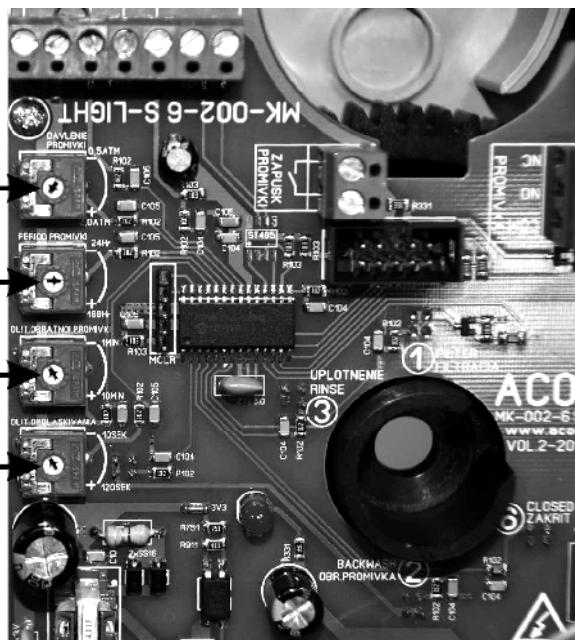
**«DAVLENIE PROMIVKI» - УСТАНОВКА ДАВЛЕНИЯ ДЛЯ НАЧАЛА ПРОМЫВКИ –** Данным потенциометром выставляется значение давления при котором запустится процесс автоматической обратной промывки фильтра, при подключении соответствующего датчика давления, крайне левое положение соответствует 0,5АТМ, крайне правое положение соответствует 2,0АТМ.
